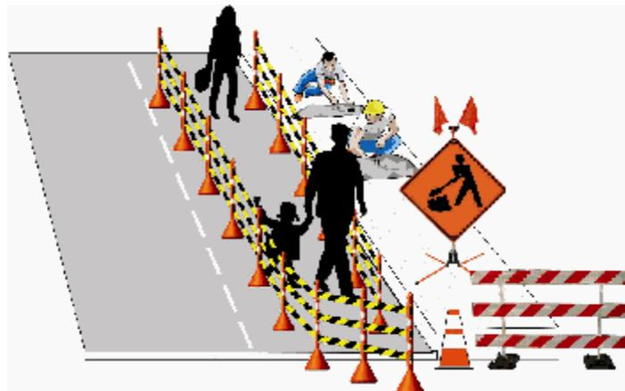
Cuando se adelanten labores de excavación en el frente de obra se debe aislar totalmente el área excavada (delimitar el área con cinta) y fijar avisos preventivos e informativos que indiquen la labor que se está realizando. Para excavaciones con profundidades mayores a 50 cm, la obra debe contar con señales nocturnas reflectantes o luminosas, tales como
